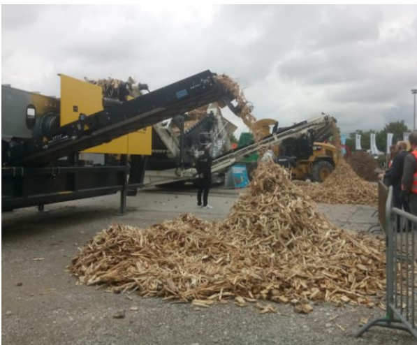
Kuvat 8 ja 9. Biomassojen käsittelymenetelmiä: puumassan sekä metallit raaka-aineesta erotteleva hakettaja työn touhussa ja kaksoiskalvotekniikkaan perustuvan maatilakohtaisen biokaasulaitoksen pienoismalli.
