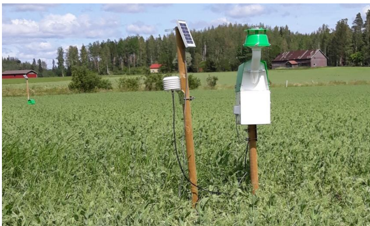
Savupiippu-mallinen etäluettava pyydys. Kuva: Marja Aaltonen, Luke.
