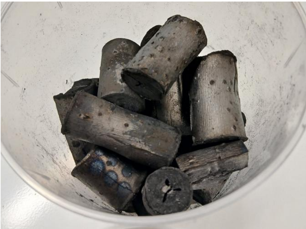
Kuva 1. Biohiileksi 680 C-asteessa pyrolysoitua pajua, XAMKin Biosampo-tutkimuslaboratorio, Kouvolassa 26.3.2025
